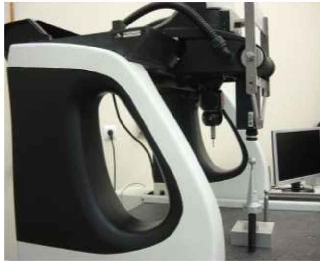
Figura 1.1: Máquina de medir por coordenadas con ambos sistemas de digitalizado.
