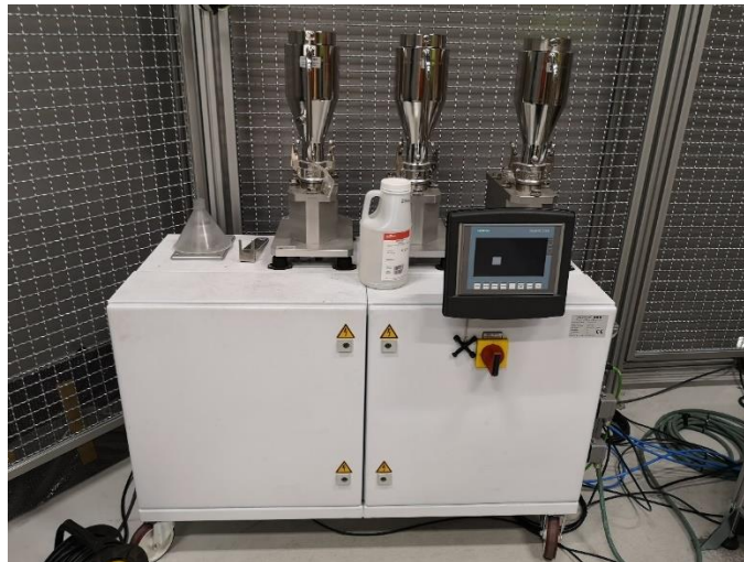
Figura 3-40: Alimentador de polvos de 3 tolvas MEDICOAT (Fuente ArcelorMittal 2020)
