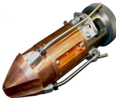
Figura 3-41: Cabezal de alimentación de polvos coaxial mediante tres boquillas
