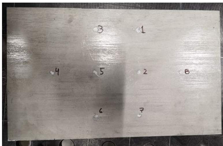
Figura 4-8: Marcado del canal y relleno de los agujeros ciegos de los termopares para el ensayo de calibración (Fuente ArcelorMittal 2020)
