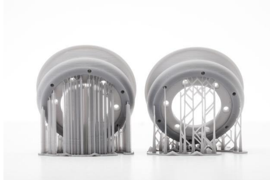
Figura 2-6: Ejemplo de soportes en la fabricación de piezas [6]
